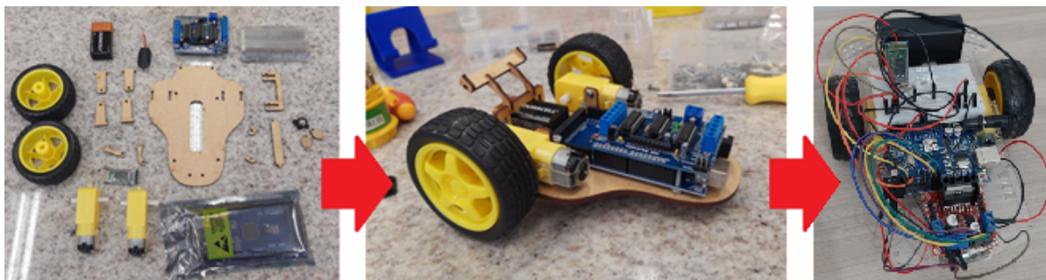
Figura 1 - Peças para montagem de carro robô, chassis com motores, placa e shield de carro montado.
